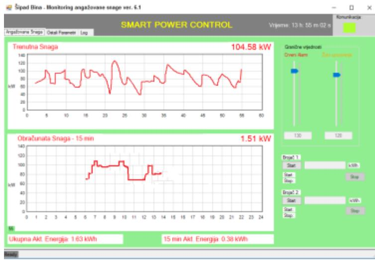
Sistem se sastoji od HW i SW dijela. HW dio čini analizator električne mreže koji se instalira na niskonaponskom dijelu mreže u proizvodnom pogonu. Najčešće se to radi na ulaznoj tački, ili, bilo gdje u pogonu gdje treba raditi mjerjenje.
